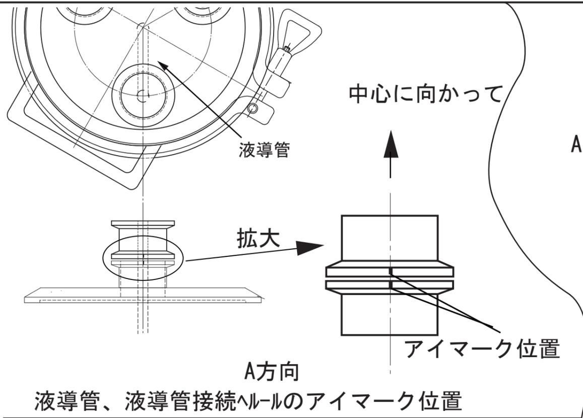
液導管、液導管接続ヘルルのアイマーク位置
